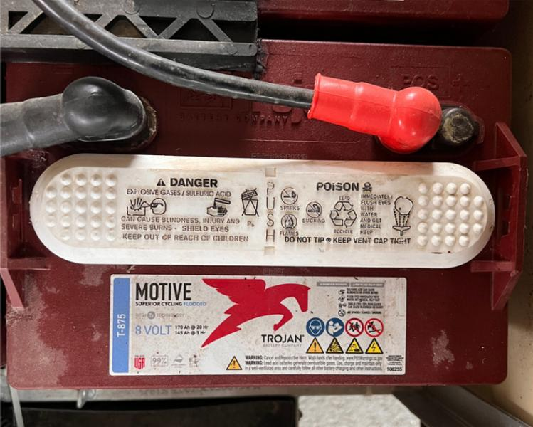
**ÉTAPE 2:** Tirer délicatement le bouchon et faites couler l'eau à l'intérieur des trous
